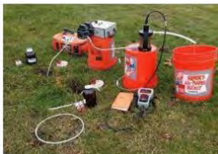
Figura 63 Modelo de bomba de baixa vazão ou low flow .
